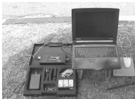
(c). Unit akuisisi dan komputer sebagai penganalisis spektrum
