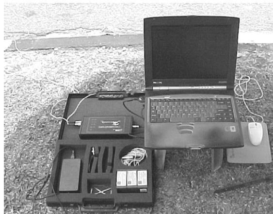
(c). Unit akuisisi dan komputer sebagai penganalisis spektrum
